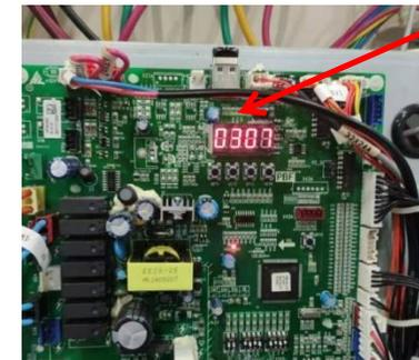
Первые две цифры обозначают количество обнаруженных контроллеров внутренних блоков
