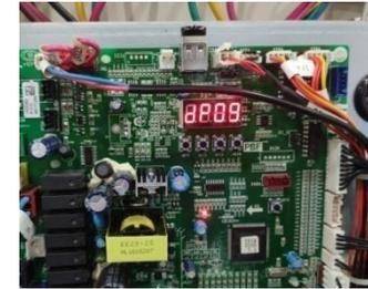
С помощью кнопок KEY2 и KEY3 установите количество внутренних блоков
