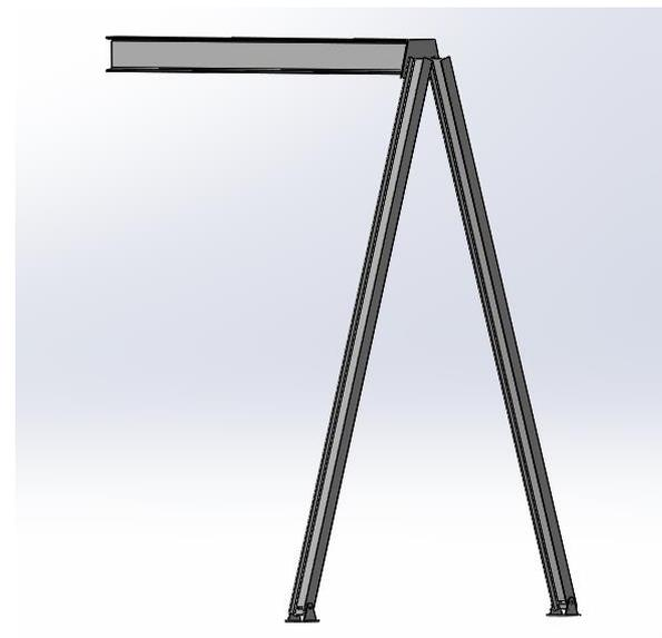
Вентилятор оборудован направляющими, которые упрощают его обслуживание. В частности, они облегчают подъем и перемещение двигателя вентилятора.
