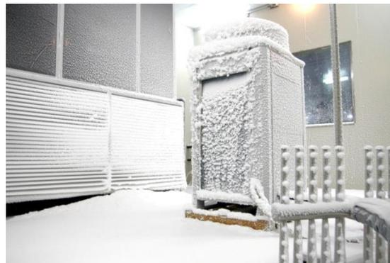
Стенд, симулирующий эксплуатацию оборудования в заснеженных условиях. Диапазон температур – от -40 до +55 °С
