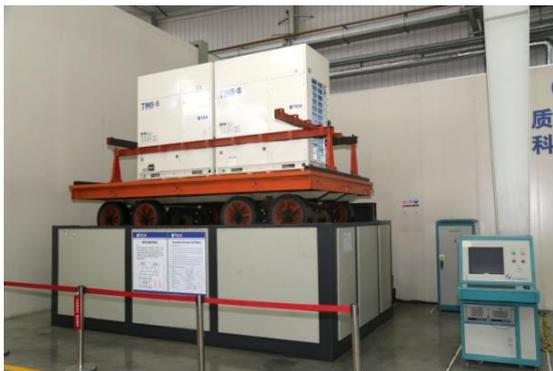
Платформа для симуляции транспортировки оборудования
