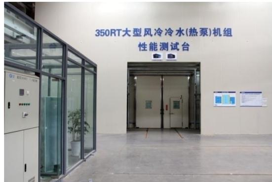
Стенд для испытаний чиллеров с воздушным охлаждением мощностью до 350RT (1231 кВт)
