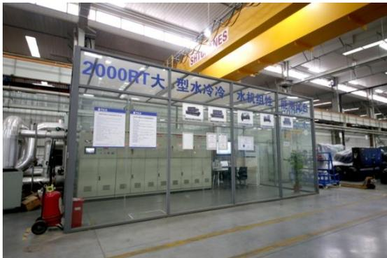
Стенд для испытаний чиллеров с водяным охлаждением мощностью до 2000RT (7034 кВт)
