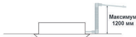
Мощность напора дренажного насоса — 1,2 м
