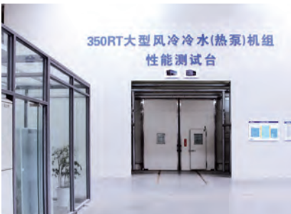
Стенд для испытаний чиллеров с воздушным охлаждением мощностью до 1231 кВт (350RT)
