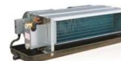
Канальные фанкойлы TCR-JR (4-трубные, 3+1-рядный теплообменник, двигатель постоянного тока, напор – 30 Па, бесступенчатое регулирование скорости)
