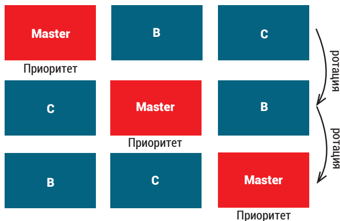
Любой модуль в гидравлическом контуре может выступать в качестве ведущего
