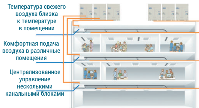
Многопоточная подача воздуха канальными блоками
