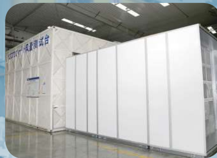
Лаборатория для проведения испытаний вентиляционных установок большой мощности
