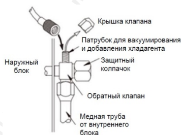
Схема обратного клапана
